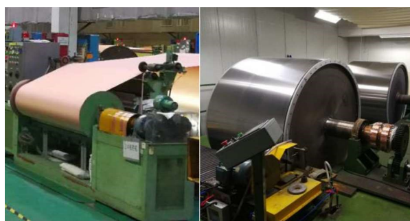
图 4 生箔机和钛合金阴极辊实物图(网络版彩图)
