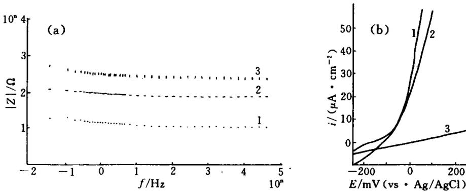
图3 磷脱氧铜在80℃不同浓度醋酸中的Bode图和阳极极化曲线
