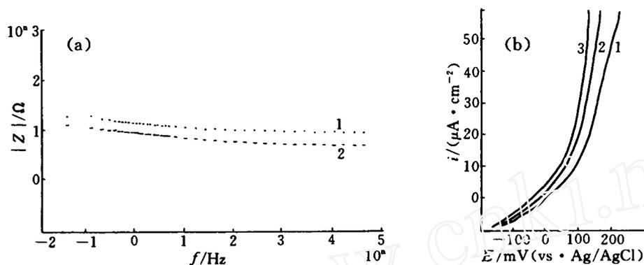
图5 磷脱氧铜在不同温度的60%醋酸溶液中的Bode图和阳极极化曲线
