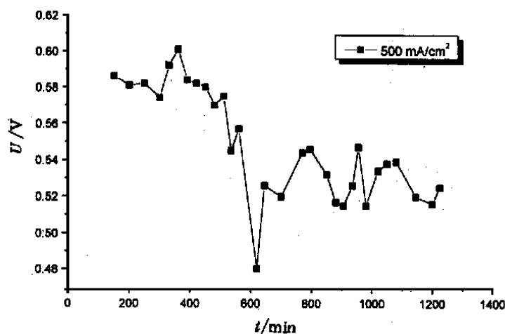
图 2 质子交换膜燃料电池:以 Pt/C 为阳极催化剂, H<sub>2</sub>/53 × 10<sup>-6</sup> CO 为燃料气,电池电压随通气时间的变化
