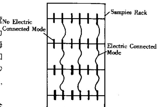
图 1 钢材试样挂片架示意图
