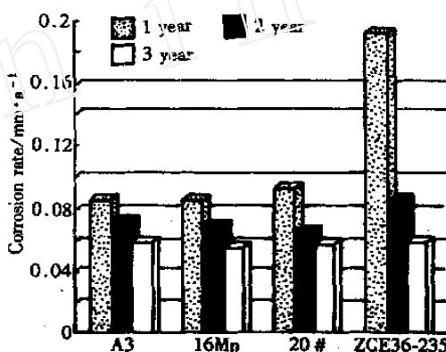
图 3 钢材腐蚀速率随埋片时间变化关系
