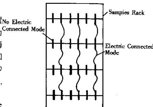
图 1 钢材试样挂片架示意图
