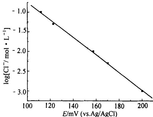
图 2 Ag/AgCl 微电极在不同浓度的 NaCl 溶液中的  $\log[\text{Cl}^-] \sim E$  响应曲线
