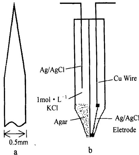
图1 Ag丝针尖(a)和复合型微Cl<sup>-</sup>电极(b)结构简图
