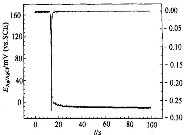
图 3 Ag/AgCl 微电极的电位-时间曲线(a)及其一阶导数曲线(b)
