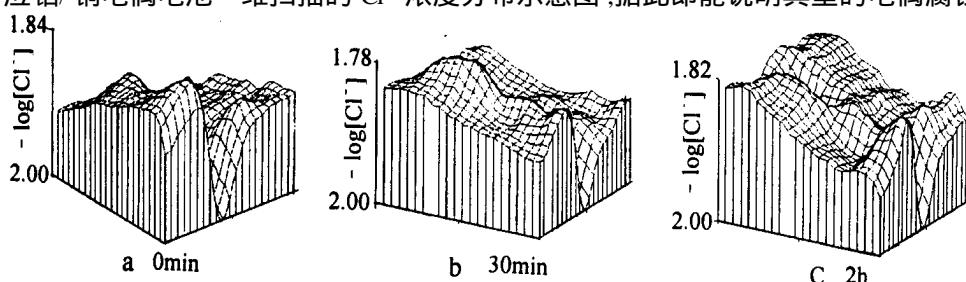
图 4 在 0.01 mol/L NaCl 溶液中 Al/Cu 表面微区 Cl<sup>-</sup> 浓度分布
