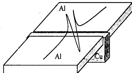
图 5 在 0.01 mol/L NaCl 溶液中 Al/Cu 表面一维  $\text{Cl}^-$  浓度分布示意图
