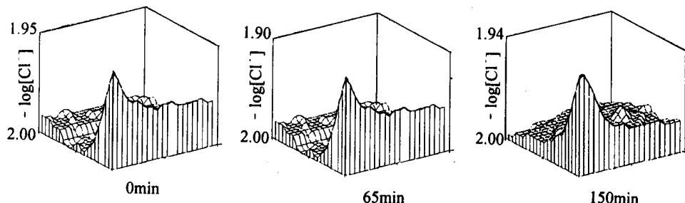
图 6 在 0.01 mol/L NaCl 溶液中 Al 2024 的微区  $\text{Cl}^-$  分布
