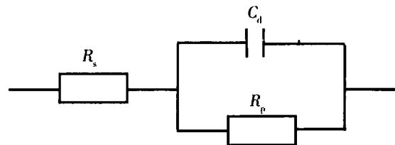
图4 A3钢电极的等效电路图
