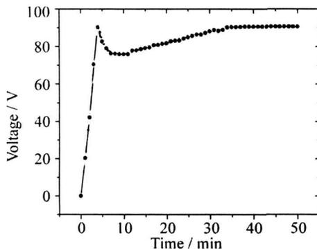
图 3 控电流法制作超亲水氧化铝表面阳极氧化  $E \sim t$  变化曲线 电流密度  $20 \text{ mA}/\text{cm}^2$
