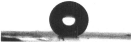
图5 超亲水氧化铝表面修饰氟硅烷后对水的接触角
