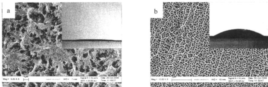
图 2 在控槽压 120 V, 阳极氧化时间 60 min, 温度 20℃ (a) 和 0℃ (b) 下制备的氧化铝的表面形貌与接触角的 SEM 照片
