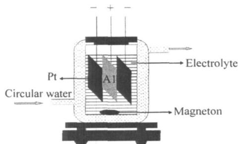
图 1 阳极氧化法制备超亲水氧化铝的实验装置图
