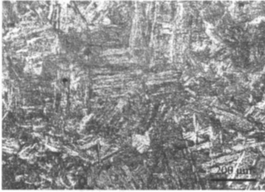
图 1 UNS J91540 不锈钢的金相组织显微照片 Fig 1 Optical micrographs of UNS J91540 stainless steel
