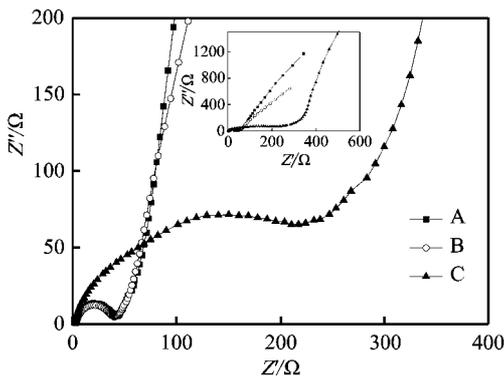
图 3 3 种  $\text{Li}_3\text{V}_2(\text{PO}_4)_3$  样品(A、B 和 C) 充放电之前的交流阻抗测试图谱,插图示意 3 条曲线的走向趋势
