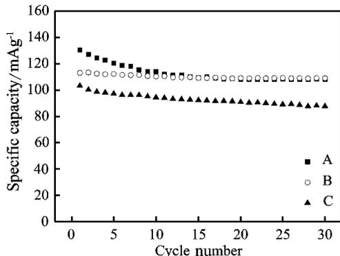
图 5 3 种  $\text{Li}_3\text{V}_2(\text{PO}_4)_3$  样品(A、B 和 C) 在  $0.2 \text{ C}$  倍率下的循环性能曲线
