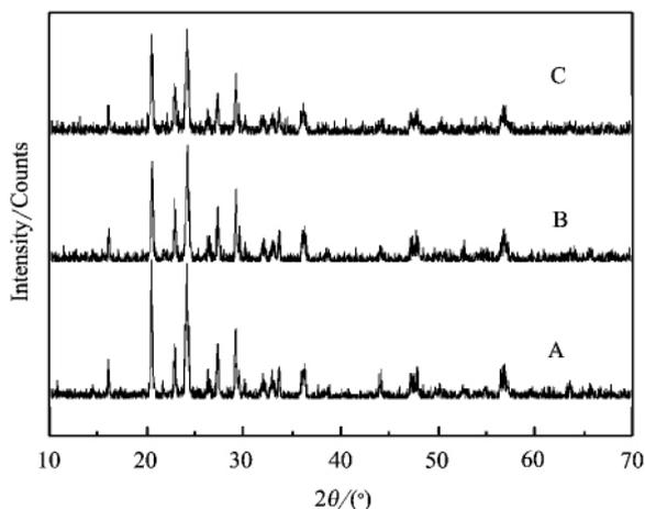
图 1 3 种  $\text{Li}_3\text{V}_2(\text{PO}_4)_3$  样品(A、B 和 C)的 X 射线衍射图谱
