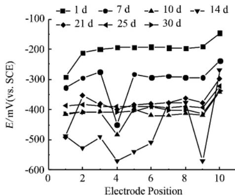
图 2 钢筋混凝土阵列微电极在 3.5% NaCl 溶液中腐蚀电位随浸泡时间的变化
