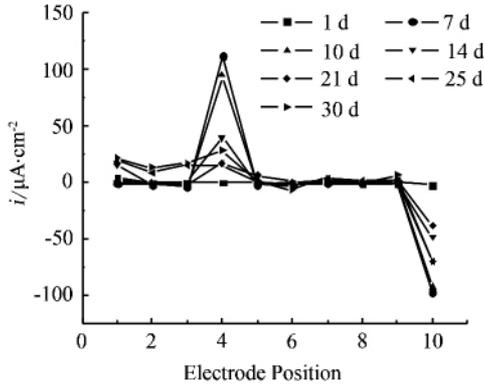
图 3 钢筋混凝土阵列电极腐蚀宏电池电流密度随浸泡时间的变化
