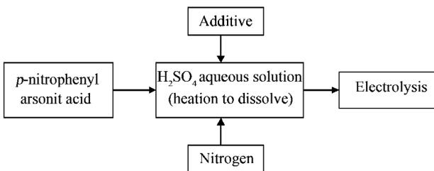
图 1 *p*-ASA 电解合成流程示意图
