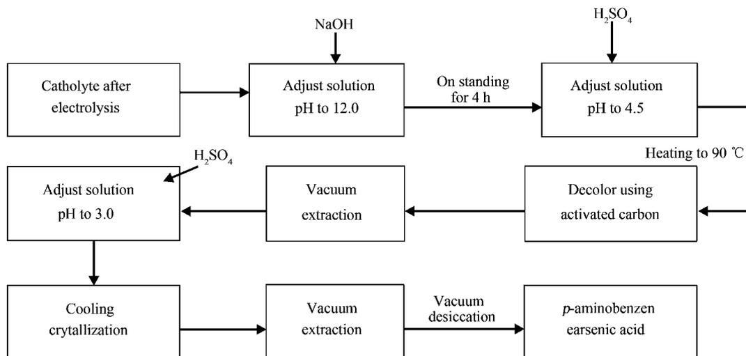
图 2 电解合成 *p*-ASA 后处理流程示意
