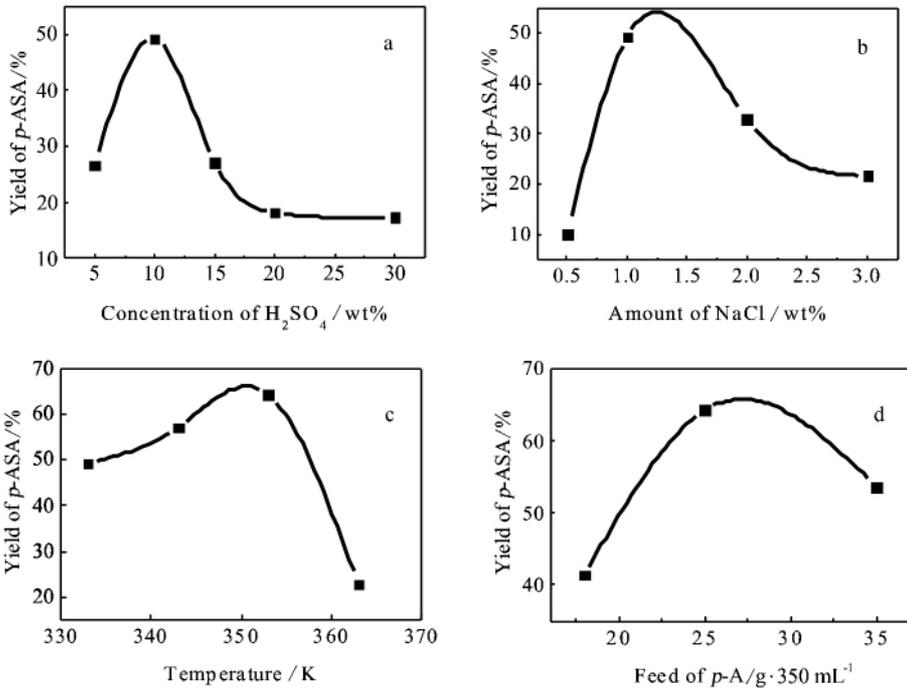
图 4 工艺条件对电合成 *p*-ASA 产率的影响
