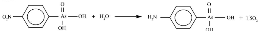
图 3 对硝基苯胂酸电解还原合成对氨基苯胂酸的反应原理
