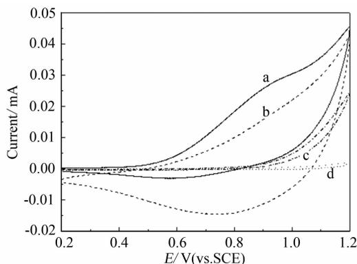
图 3 片层纺锤形纳米 CuO 修饰电极(a,b)和裸 GC 电极(c,d)在空白  $0.01 \text{ mol} \cdot \text{L}^{-1}$  PBS 溶液( $\text{pH} = 7$ )中(b,d)及其含有  $1 \text{ mmol} \cdot \text{L}^{-1}$   $\text{H}_2\text{O}_2$  ( $\text{pH} = 7$ )溶液中(a,c)的 CV 曲线(扫描:  $50 \text{ mV} \cdot \text{s}^{-1}$ )
