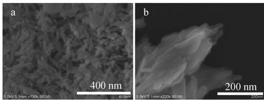
图 1 CuO 纳米粒子的扫描电镜(SEM)照片(a)及其局部放大照片(b)
