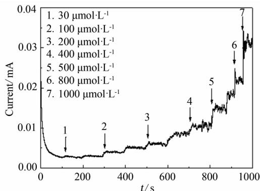
图 4 片层纺锤形纳米 CuO 修饰电极在  $\text{pH} = 7$  PBS 溶液中搅拌条件下连续依次注入  $5, 10, 30, 50, 100, 150, 200, 300, 400, 500, 600, 800, 1000 \mu\text{mol} \cdot \text{L}^{-1} \text{H}_2\text{O}_2$  的计时电流曲线 (操作电压  $0.9 \text{ V}$ )
