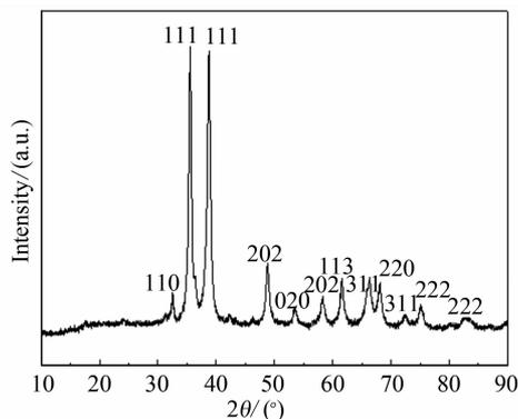
图 2 片层纺锤形纳米 CuO 的 XRD 图谱
