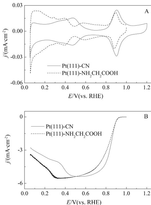
图 5 甘氨酸修饰的 Pt(111) 电极(虚线所示)与 CN<sup>-</sup> 修饰的 Pt(111) 电极(实线所示)分别在 Ar 饱和的(A)和 O<sub>2</sub> 饱和的(B) 0.05 mol·L<sup>-1</sup> H<sub>2</sub>SO<sub>4</sub> 溶液中的循环伏安曲线(A)和极化曲线(B)(B 图中, 向电位正方向扫描, 电极转速 1500 r·min<sup>-1</sup>)
