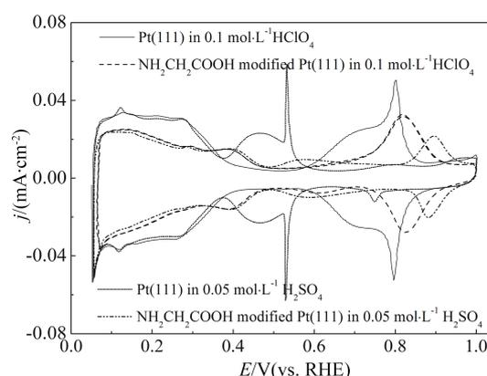
图 1 Ar 饱和的  $0.1 \text{ mol} \cdot \text{L}^{-1} \text{HClO}_4$  或  $0.05 \text{ mol} \cdot \text{L}^{-1} \text{H}_2\text{SO}_4$  溶液中, Pt(111) 与甘氨酸修饰的 Pt(111) 电极的循环伏安曲线(扫描速率  $50 \text{ mV} \cdot \text{s}^{-1}$ )
