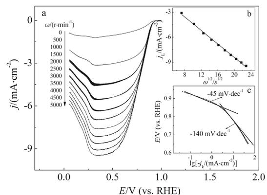
图 2 甘氨酸修饰的 Pt(111)电极在氧饱和的  $0.05 \text{ mol}\cdot\text{L}^{-1} \text{ H}_2\text{SO}_4$  溶液中不同转速下以  $50 \text{ mV}\cdot\text{s}^{-1}$  扫描速率正电位方向扫描的氧还原极化曲线(a)、氧还原的 Levich 曲线(b)和  $1500 \text{ r}\cdot\text{min}^{-1}$  下氧还原的 Tafel 曲线(c)
