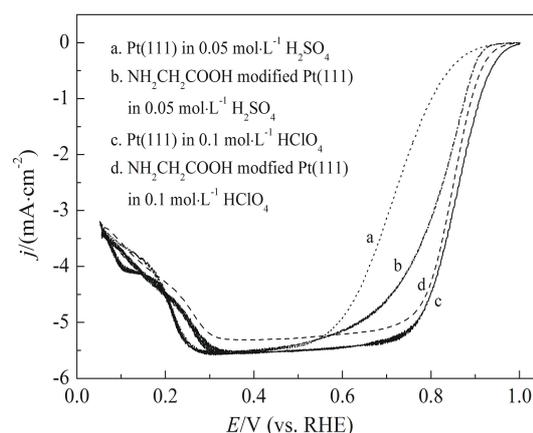
图 4 Pt(111) 与甘氨酸修饰的 Pt(111) 电极在  $\text{O}_2$  饱和的  $0.05 \text{ mol} \cdot \text{L}^{-1} \text{ H}_2\text{SO}_4$  及  $0.1 \text{ mol} \cdot \text{L}^{-1} \text{ HClO}_4$  溶液中于  $1500 \text{ r} \cdot \text{min}^{-1}$  转速下  $50 \text{ mV} \cdot \text{s}^{-1}$  向电位正方向扫描的氧还原极化曲线
