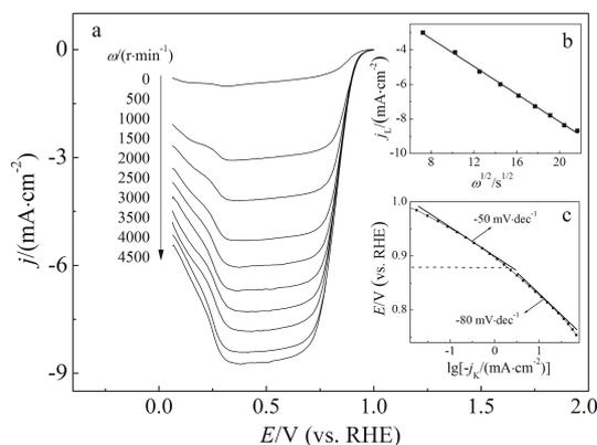
图 3 甘氨酸修饰的 Pt(111) 电极在氧饱和的  $0.1 \text{ mol} \cdot \text{L}^{-1} \text{ HClO}_4$  溶液中于不同转速下  $50 \text{ mV} \cdot \text{s}^{-1}$  向电位正方向扫描的氧还原极化曲线(a)、氧还原的 Levich 曲线(b)和  $1500 \text{ r} \cdot \text{min}^{-1}$  下氧还原的 Tafel 曲线(c)
