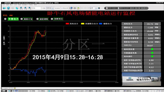
图 4 储能电站在执行平滑出力功能时的实时运行曲线 Fig. 4 Wind smoothing function by VFB energy storage system
