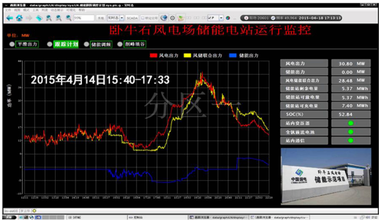
图 5 储能电站在执行计划发电功能时的实时运行曲线 Fig. 5 Schedule tracking function by VFB energy storage system
