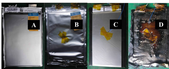
图 7 电池的挤压测试
