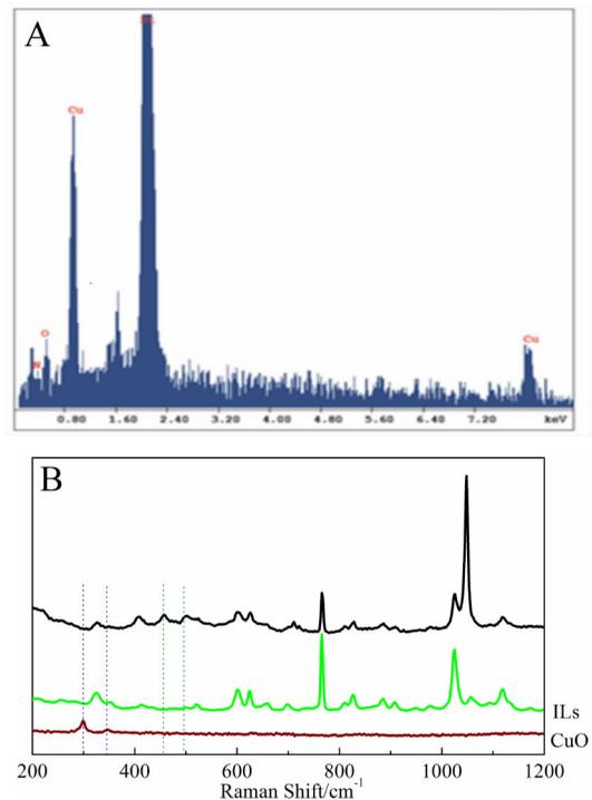
图 5 沉积点的 EDS 能谱分析(A)和拉曼光谱图(B)
