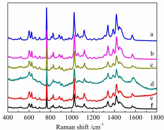
图 7 Pt 表面的 SERS 谱图 (a)体相;(b)~(f) 沉积点外
