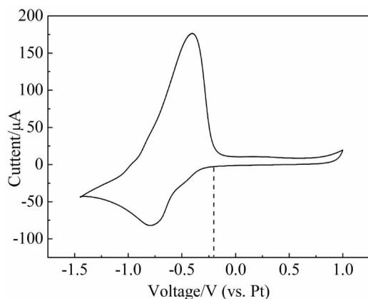
图 1 Pt 电极在 [BMIm]BF<sub>4</sub> + 0.05 mol·L<sup>-1</sup> Cu(NO<sub>3</sub>)<sub>2</sub>·3H<sub>2</sub>O 溶液中的循环伏安曲线 扫描速率: 100 mV·s<sup>-1</sup>
