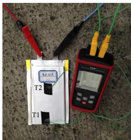
图 2 过充实验中热电偶及温度测试位置
