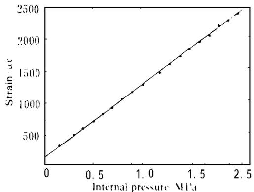
图 1 电池内压  $P$  与壳体应变值 标定装置
