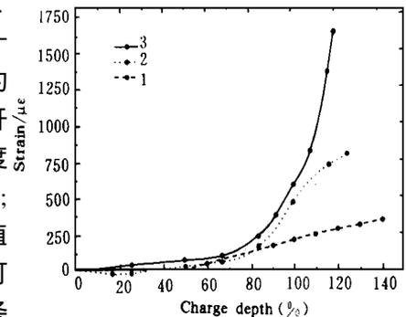
图 4 AA 型 Ni/MH 电池不同电流充电时应力 (内压) 变化曲线
