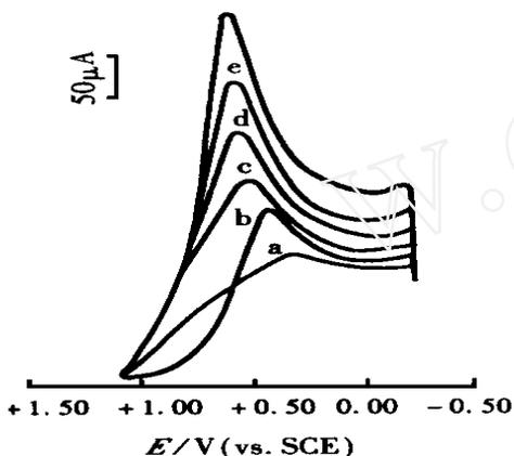
图2 还原菌修饰的碳糊电极在不同 pH 值的  $84.70 \mu\text{g/mL}$   $AuCl_3$  溶液中的阴极溶出伏安曲线
