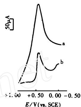
图 1 有 (a)、无 (b) 细菌修饰的碳糊电极在 84.70 μg/mL AuCl<sub>3</sub> 溶液中的阴极溶出伏安曲线 (pH = 1.18)。
