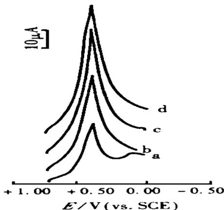
图3 还原菌修饰碳糊电极在  $50 \mu\text{g/mL}$   $AuCl_3$  溶液中不同富集时间的阴极溶出伏安曲线
