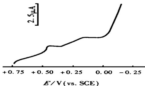
图 5 还原菌修饰的碳糊电极在 1 ng/mL AuCl<sub>3</sub> 溶液中阴极溶出伏安曲线
