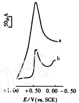
图 1 有 (a)、无 (b) 细菌修饰的碳糊电极在 84.70 μg/mL AuCl<sub>3</sub> 溶液中的阴极溶出伏安曲线 (pH = 1.18)。
