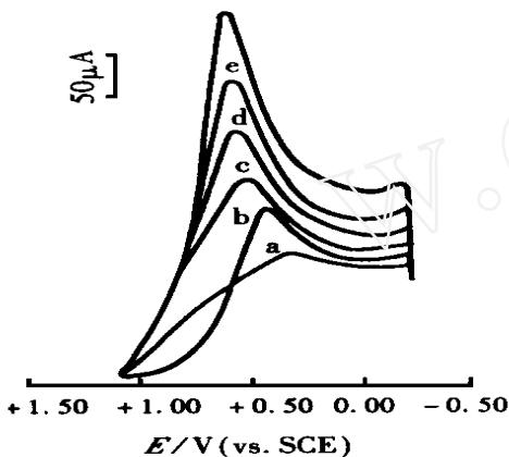
图 2 还原菌修饰的碳糊电极在不同 pH 值的  $84.70 \mu\text{g}/\text{mL}$   $AuCl_3$  溶液中的阴极溶出伏安曲线
