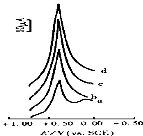
图 3 还原菌修饰碳糊电极在  $50 \mu\text{g}/\text{mL}$   $AuCl_3$  溶液中不同富集时间的阴极溶出伏安曲线
