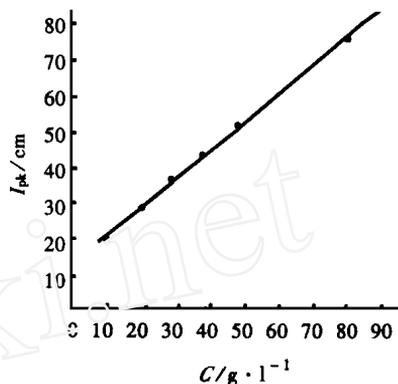
图 4 Au(Ⅲ)在还原菌修饰碳糊电极上的阴极溶出峰电流与 AuCl<sub>3</sub> 浓度的线性关系
