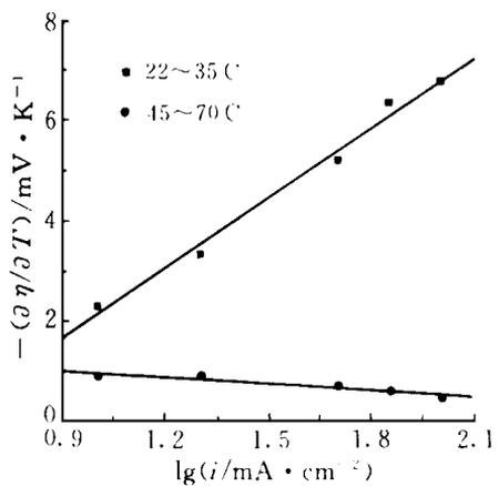
图 4 镍电极阳极析氧高过电位极化区的  $-(\partial \eta / \partial T)_i \sim \lg i$  关系曲线
