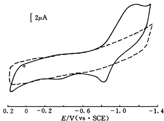
图 1  $\text{VB}_{12}$  在光滑银电极上的循环伏安图
