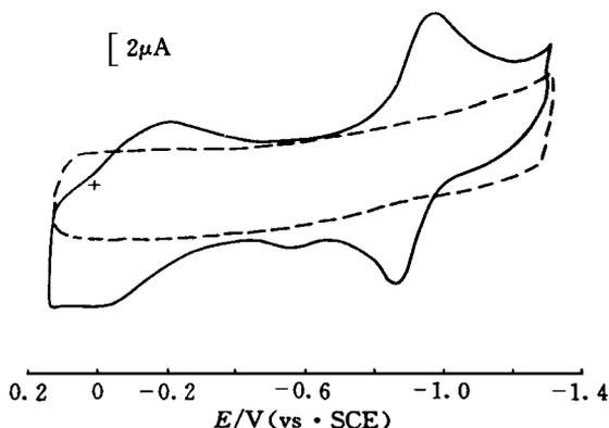
图 2  $\text{VB}_{12}$  在粗糙化银电极上循环伏安图
