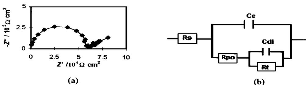
图 1 铜表面涂装阳离子选择性涂层在 3% NaCl 溶液中浸泡 14 d 的 Nyquist 图及其等效电路
