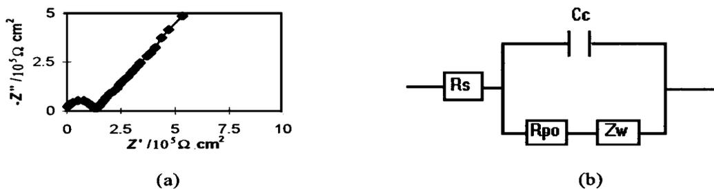
图 2 铜表面涂装阴离子选择性涂层在 3% NaCl 溶液中浸泡 14 天的 Nyquist 图(a)及其等效电路(b)
