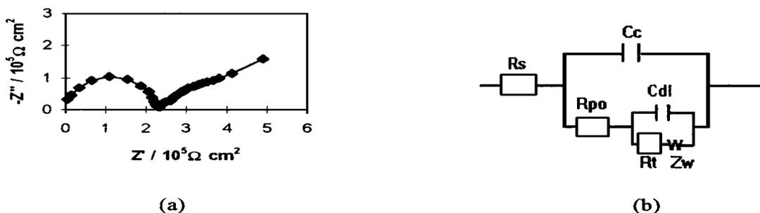
图 3 铜表面涂装阳离子选择性/阴离子选择性涂层在 3% NaCl 溶液中浸泡 14 天的 Nyquist 图(a)及其等效电路(b)
