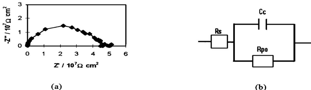
图 4 铜表面涂装阴离子选择性/阳离子选择性涂层在 3% NaCl 溶液中浸泡 14 天的 Nyquist 图及其等效电路
