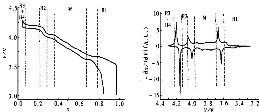
图 2  $\text{LiNiO}_2$  的充放电曲线及其微分曲线
