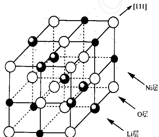
图1 层状 $\text{LiNiO}_2$ 的晶体结构示意图
