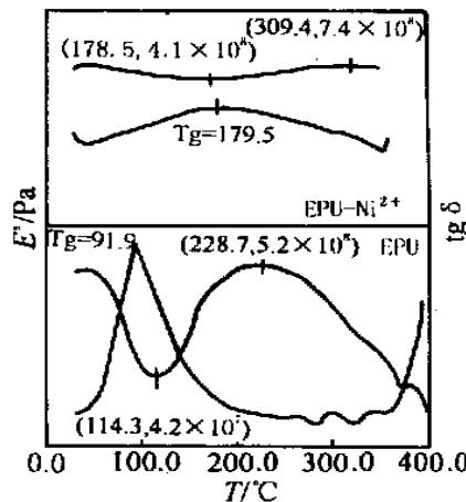
图 3 EPU 和 EPU- $\text{Ni}^{2+}$  的 DMTA 谱图Fig. 3 DMTA curves of EPU and EPU- $\text{Ni}^{2+}$
