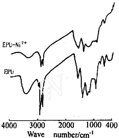
图 2 EPU 和 EPU- $\text{Ni}^{2+}$  的红外光谱Fig. 2 FT-IR spectra of EPU and EPU- $\text{Ni}^{2+}$
