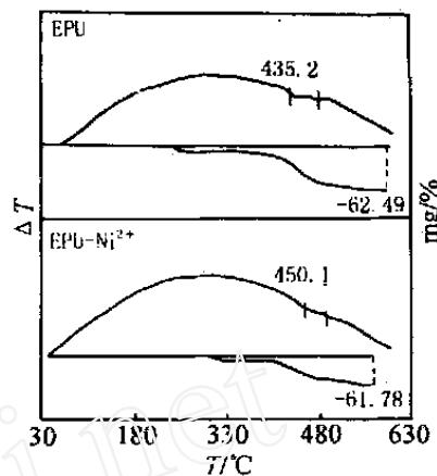
图 4 EPU 和 EPU-Ni<sup>2+</sup> TG-DTA
