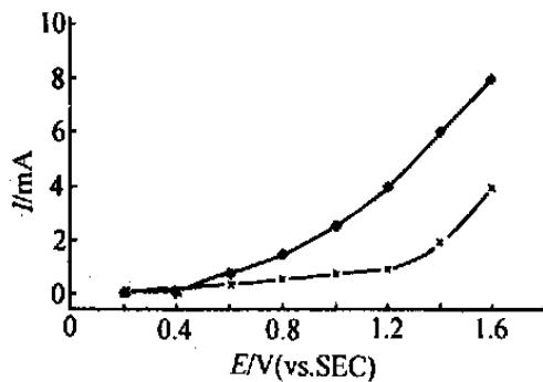
图 1 漆酚在不同电极上的电化学聚合反应的稳态极化曲线
