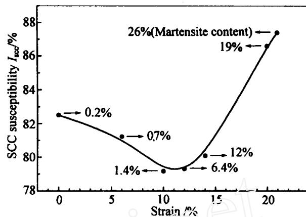
图3 304不锈钢在42% MgCl<sub>2</sub>沸腾溶液中的应力腐蚀敏感性与变形量的关系
