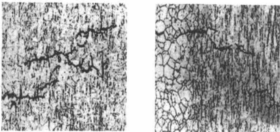
图4 42% MgCl<sub>2</sub> 沸腾溶液中304不锈钢应力腐蚀裂纹金相照片
