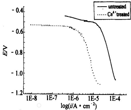
图 2 LY12 铝合金经铈盐处理前后的阴极极化曲线
