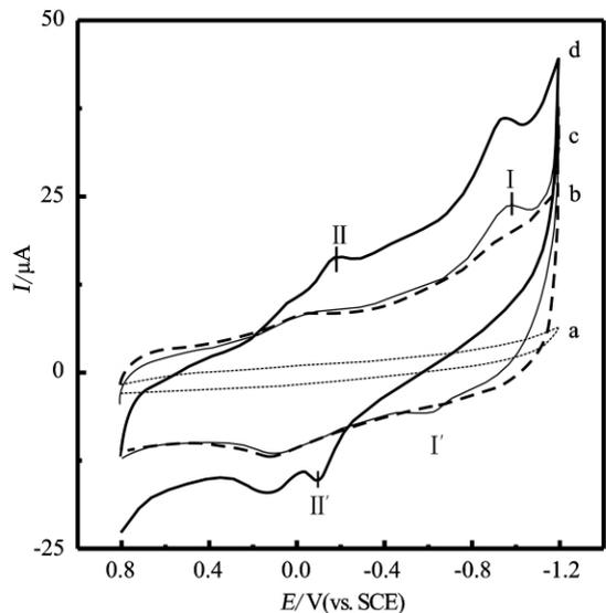
图 3 裸 GCE (a) ,PS/石墨/GCE (b) ,PS/CoAPO-5/GCE (c) 和 PS/CoSALEN/APO-5/GCE (d) 在 pH = 6.86 的缓冲溶液中 (氮气饱和) 的循环伏安曲线 (扫描:  $50 \text{ mV} \cdot \text{s}^{-1}$ )
