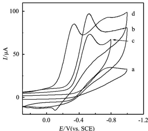
图 7 裸 GCE (a) ,PS/石墨/GCE (b) ,PS/CoAPO-5/GCE (c) 和 PS/CoSALEN/APO-5/GCE (d) 在 O<sub>2</sub> 饱和 pH 6.86 的混合磷酸盐溶液中循环伏安曲线 (扫速为 50mV · s<sup>-1</sup>)
