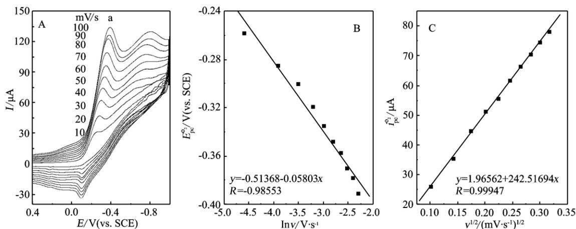
图 8 PS/CoSALEN/APO-5/GCE 修饰电极在氧气饱和的 pH 6.86 的 PBS 中的循环伏安曲线 (v = 10 ~ 100 mV · s<sup>-1</sup>) (A) 及其氧气在此修饰电极上 E<sub>pc</sub><sup>O<sub>2</sub></sup> ~ ln(v) 的变化 (B) 和氧气在此修饰电极上 i<sub>pc</sub><sup>O<sub>2</sub></sup> ~ v<sup>1/2</sup> 的变化关系 (C)
