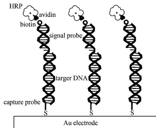
图 1 酶联放大安培检测技术示意图
