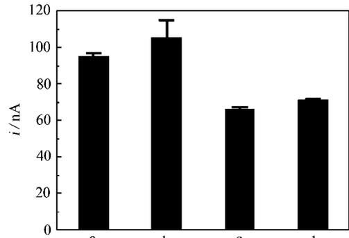
图 4 BSA 封闭 (15 min 和 1 h) 金电极上酶前后在 TMB (K-Blue 原液) 的响应电流
