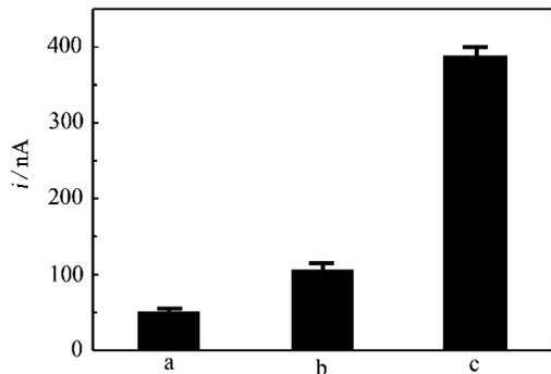
图 5 裸电极及用不同封闭方式封闭后在 TMB( K-Blue 原液) 中的电流信号
